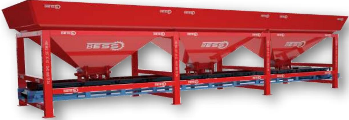
LA TRÉMIE DU SABLE, GRAVIER ET DU POUDRE DE PIERRE. DANS CHAQUE COMPARTIMENT IL YA 1 OUVERTURE POUR LE DECHARGE DES AGREGATS. LE CHASSIS A ETE FABRIQUÉ EN RESPECTANT LES QUALITÉS, LES NORMES ISO 9001 ET EN RESPECTANT AUSSI TOUTES LES NORMES DIN DE 150 x 100 x 6 mm. PROFILE ET EN UTILISANT DES DIVERS MODELES D'ÉPAISEUR DE METAL. LE VIBROTEUR SE TROUVANT AU DESSOUS DU TREMIE PERMET DE FAIRE DESCENDRE PLUS RAPIDEMENT LES AGREGATS.
