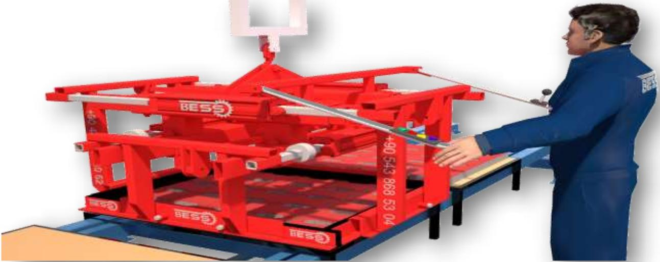
PRODUITS SÉCHÉS VENANT DU ROBOT DEPÎLEUR, LA PRÎSE EN CHARGE DES PRODUITS PERMET L'EMPÎLAGE SUR LES PALETTES D'EXPÉDITION. EFFECTUER LE MOUVEMENT PAR LE SYSTÈME PNEUMATIQUE. POÎNT DE COLLECTE UNÏQUE ET PERMET RAPÏDEMENT DE FAÏRE. AVEC LE MOTEUR EN MARCHÉ ET LE BRACELET FAÏT DE GAUCHE À DROÏTE ET DE HAUT EN BAS MOUVEMENT. PUÏSSANCE DU MOTEUR DE 0,2 kw EST.
