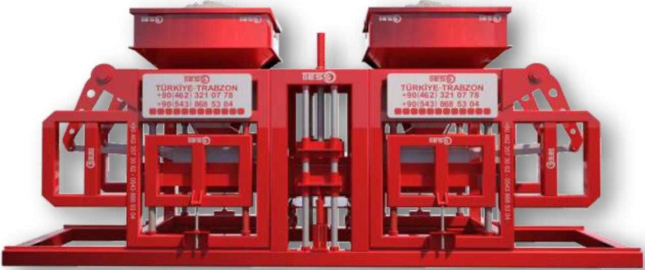
SYSTÈME DE VIBRATION / PUISSANCE VIBRATION 36.500 KG
