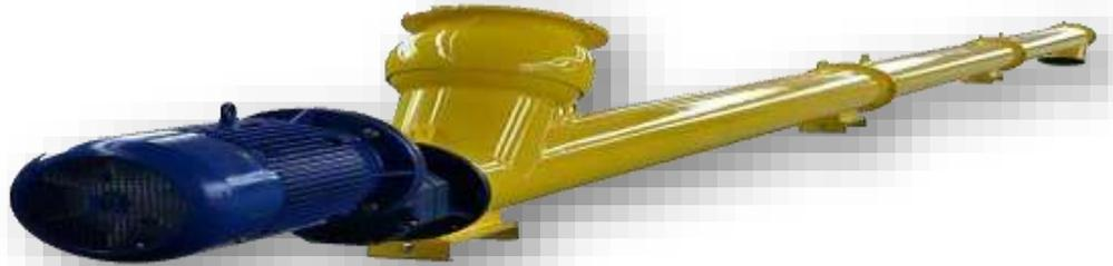
C'EST L'ÉQUIPEMENT QUI TRANSFÈRE LE CIMENT NECESSAIRE DU MORTIER AU SYSTEME DE PESAGE. LA MARQUE EST DE WAM 8'' ( Ø219 mm ). PUISSANCE DU MOTEUR EST DE **9.2 Kw** ET LE POINT DE LIAISONS DU SILO ET MOBILE.
