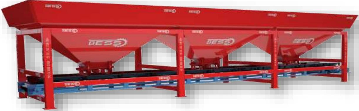
LA TRÉMIE DU SABLE, GRAVIER ET DU POUDRE DE PIERRE. DANS CHAQUE COMPARTIMENT IL YA 1 OUVERTURE POUR LE DECHARGE DES AGREGATS. LE CHASSIS A ETE FABRIQUÉ EN RESPECTANT LES QUALITÉS, LES NORMES ISO 9001 ET EN RESPECTANT AUSSI TOUTES LES NORMES DIN DE 150 x 100 x 6 mm. PROFILE ET EN UTILISANT DES DIVERS MODELES D'ÉPAISSEUR DE METAL. LE VIBROTEUR SE TROUVANT AU DESSOUS DU TREMIE PERMET DE FAIRE DESCENDRE PLUS RAPIDEMENT LES AGREGATS.
